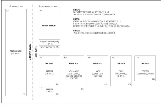
Figure 17. DS1859-Compatible Configuration (Mode Bit = 1)
