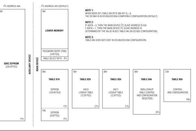
Figure 16. DS1852/DS1856-Compatible Configuration (Mode Bit = 0, Default)
